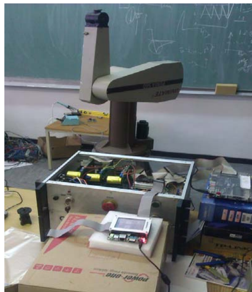
Slika 7. Upravljačko okruženje za robot PUMA 560
