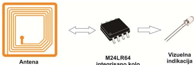
Slika 2. Blok šema RFID oznake.
