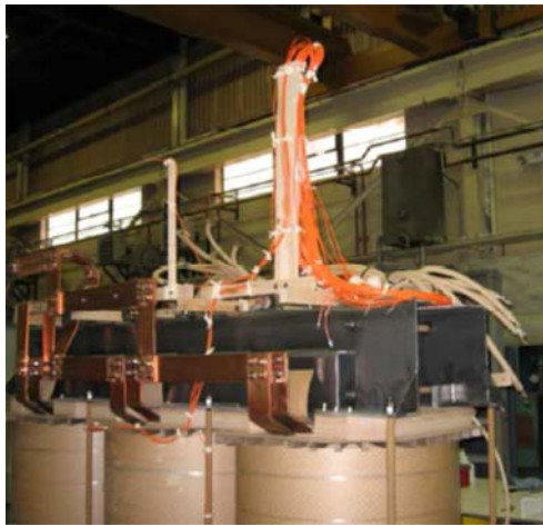
Slika 2. Instalacija optičkih, termičkih senzora tokom proizvodnje [9]
