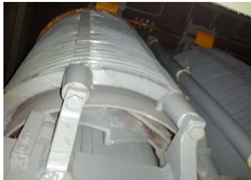
Slika 4. Prikaz namotaja testiranog transformatora (pogled odozgo)
