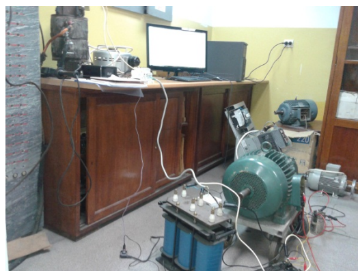
Slika 3. Praktična realizacija sistema za detekciju asimetričnog napajanja asinhronne mašine sa namotanim rotorom
