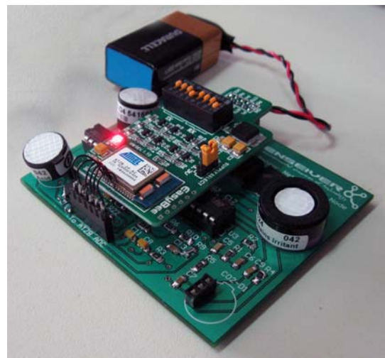
Slika 6. Izgled realizovanog bežičnog senzorskog čvora
