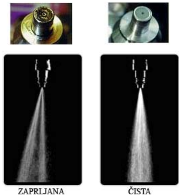
Slika 3. Izgled i formiranje mlaza čistih i zaprljanih brizgaljki
