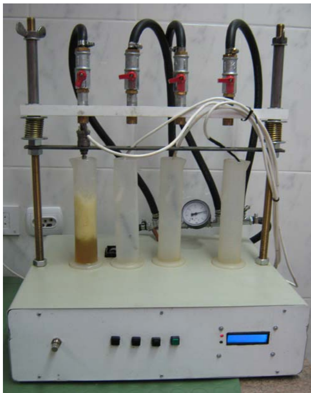
Slika 6. Uređaj za kontrolu rada brizgaljki benzinskih motora
