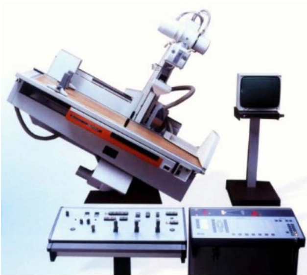
Slika 3. Telestatix sa komandnim pultom i generatorom X-zračenja
