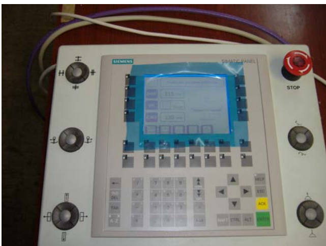
Slika 5. Izgled novog komandnog pulta sa SIMATIC PANEL-om
