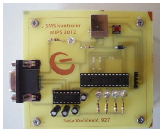
Slika 10. Štampana pločica sa isprogramiranim mikrokontrolerom
