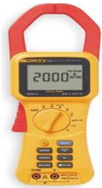
Slika 6. Analizator mreže Fluke 315 i način vezivanja analizatora na mrežu
