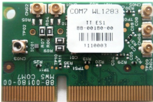
Slika 5. Prikaz Murata COM7 modula.
