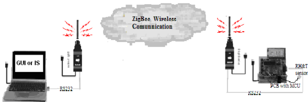
Slika 7. Koncept rješenja integracije na primjeru praćenje temperature i relativne vlažnosti [13]
