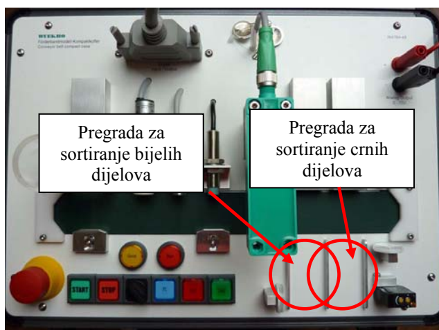
Slika 3. Stanica za simulaciju sa istaknutim pregradama za sortiranje crnih i bijelih dijelova
