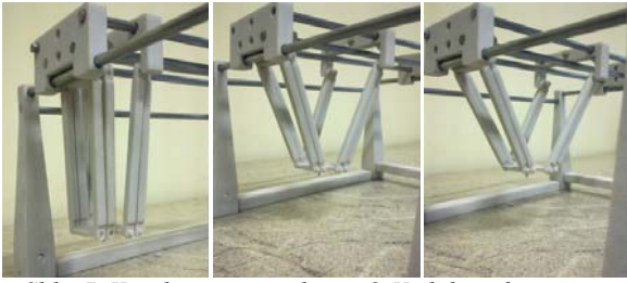
Slika 7. Karakteristični položaji O-X glide mehanizma u opruženom obliku
