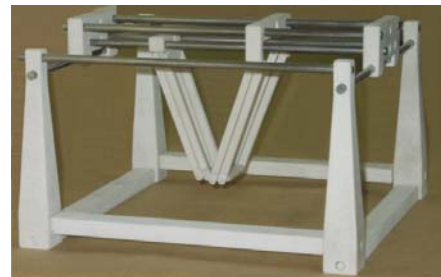
Slika 6. Prototip hibridnog O-X glide mehanizma
