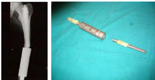
Slika 10. Prelom „Spacer“ endoproteze butne kosti
