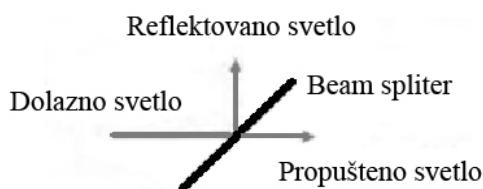
Slika 4. Deljenje svetlosti na beam spliteru [1]
