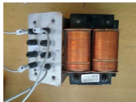
Слика 5. Једнофазни трансформатор који је предмет истраживања
