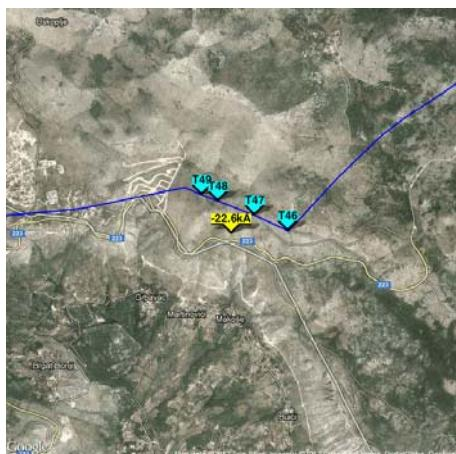
Slika 6. Dalekovod TR\_DU: Grom amplitude -22,6 kA udara u stub 47.
