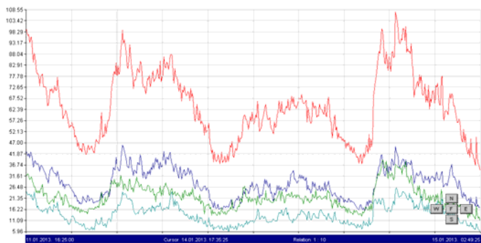
Slika 5.a Srednja vrijednost prividne snage po fazama kao i ukupna prividna snaga S [kVA] na karakterističnom mjernom mjestu 4
