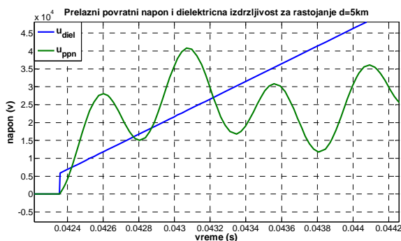
Slika 11. Prelazni povratni napon i dielektrična izdržljivost za rastojanje d=5\text{km} dobijeni simulacijom
