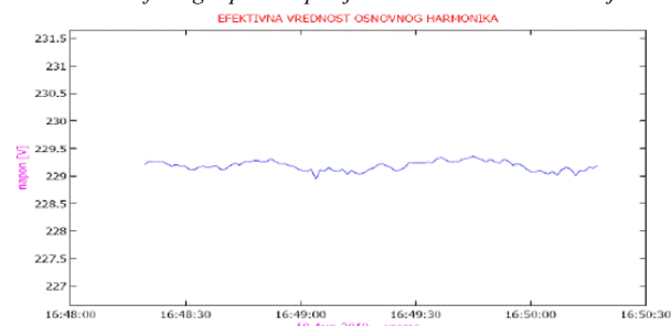
Slika 6. Efektivna vrijednost faznog napona osnovnog harmonika
