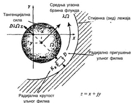
Сл.2. Сензорски систем и одговарајући динамички модел рукавца у клизном лежају
