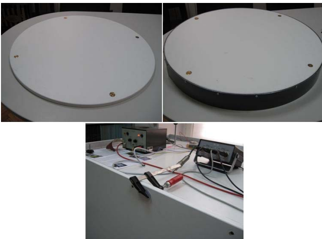
Sl. 10. Merenje sa standardnom baznom pločom (gore levo), sa podebljanom pločom (gore desno) i sa dodatnim zaptivanjem (dole)
