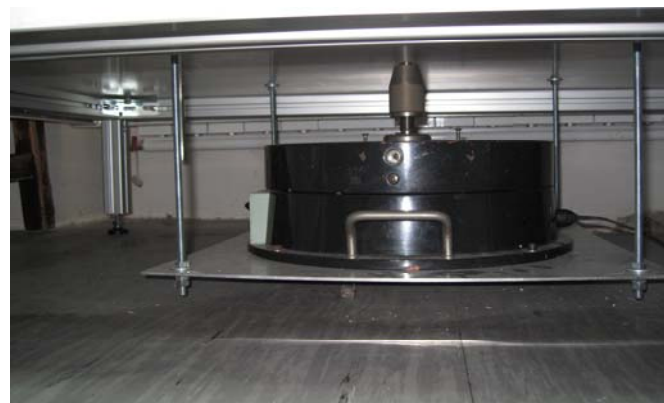
Sl. 5. Motor za ravnomernu rotaciju postolja
