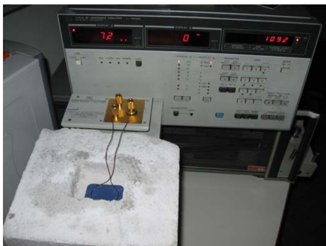
Sl. 7. Postavka mernog seta (siporeks blok, senzor, antenski namotaj, instrument)
