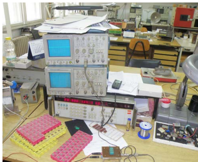
Slika 4. Merna oprema za kontrolu rada oscilatora.
