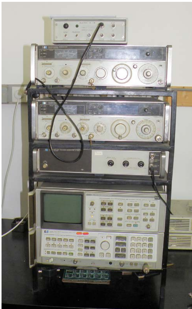
Slika 3. Analizator spektra koji se koristi za merenje na oscilatoru.
