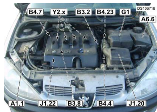
Slika 2. Raspored komponenti u motornom prostoru (A 1.1=ECU motora, J1.22= Pumpa visokog pritiska (PVP), B3.8= Davač temperature goriva, B4.4= Davač broja obrtaja kolenastog vratila sa referentom oznakom, B4.7= Davač pozicije bregastog vratila, Y2.x= Brizgaljke, itd.)
