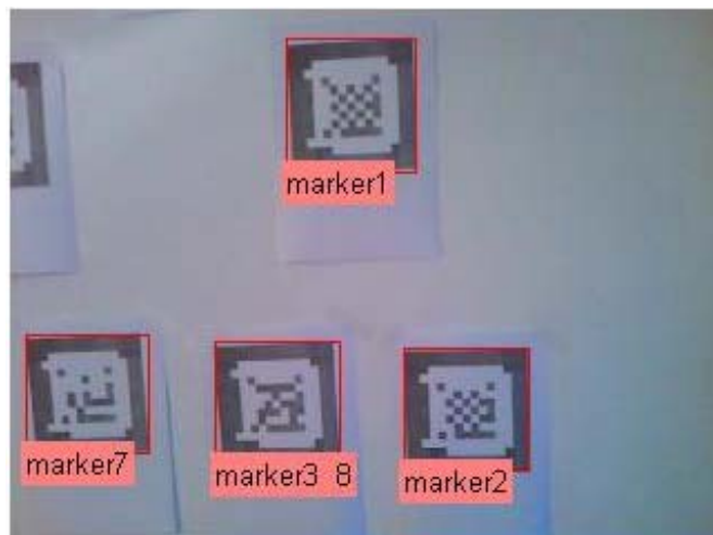
Slika 9. Slučaj detekcije većeg broja markera
