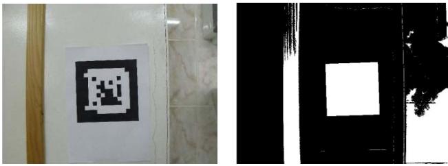
Slika 4. Binarizacija slike u procesu izdvajanja markera. Isključena je mogućnost izdvajanja jedne unutar druge komponente
