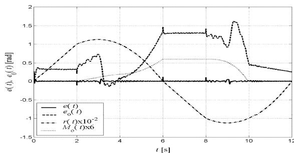
Sl. 17. Greška praćenja sistema sa i bez primene AEP.
