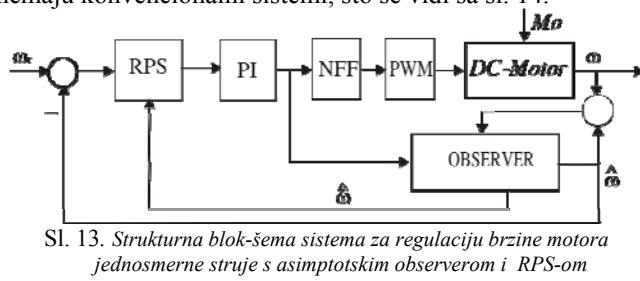
Sl. 13. Strukturalna blok-sHEMA sistema za regulaciju brzine motora jednosmerne struje s asimptotskim observerom i RPS-om
