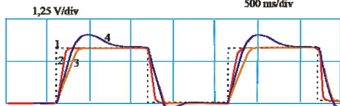
Sl. 14. Odzivi sistema sa sl. 13. 1 - referenca brzine, 2 - odzivi SUPS-a i konvencionalnog sistema sa PI regulatorom u nominalnim uslovima; 3,4 - odziv SUPS-a i konvencionalnog sistema sa PI regulatorom, respektivno, sa trostruko većim momentom inercije na vratilu motora.
