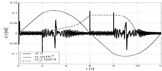
Sl. 18. Greška praćenja sistema sa AEP (zumirano).
