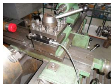
Slika 3. Eksperimentalno određivanje modalnih parametara sistema nosač alata/alat
